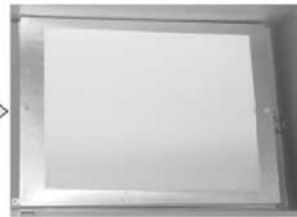
Filter beladen mit 2 g Feinstaub (vorwiegend Salze)
